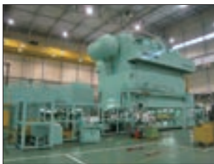
1分間に最高で33ショットが可能な 2000tトランスファープレス機
