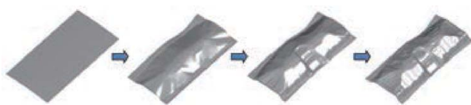
Press die formation simulation
